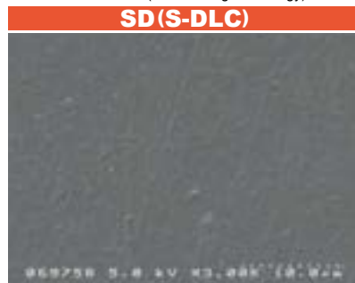
超平滑 (新フィルタリング技術) Ultra smooth (New filtering technology)
