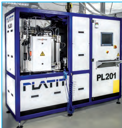
Forno di rivestimento Coating plant - Four de revêtement
