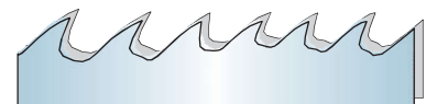
Passo variabile: gruppi di denti con passo variabile Variable pitch: groups of teeth with variable pitch
